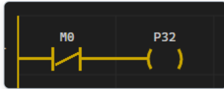
&lt; 그림 5-5 NC 접점 예제 — M0 OFF, P32 ON(통전) &gt;
