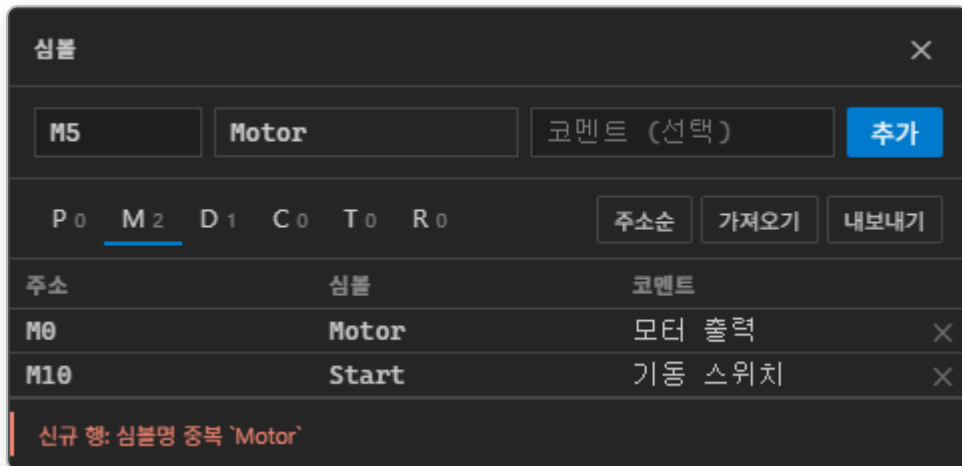
< 그림 9-8 이름 규칙 위반 — 규칙을 어긴 입력은 등록되지 않고 표 아래에 이유가 표시된다 >
