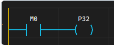
< 그림 5-2 NO 접점 기본 예제 — M0 OFF, P32 OFF(통전 없음) >
