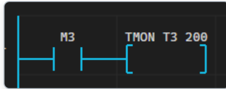
< 그림 6-7 TMON 예제 회로 — M3 NO 접점으로 TMON T3 200 구동 >
