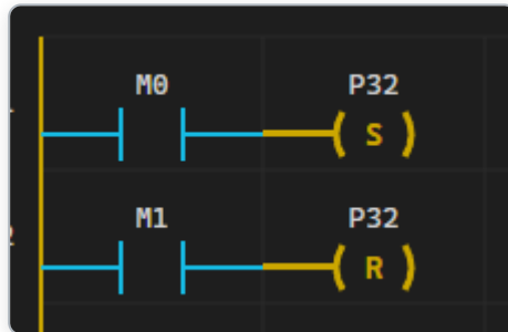
< 그림 5-10 SET 코일 예제 — M0 OFF로 복귀해도 P32는 ON 유지 >
