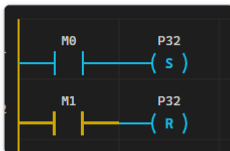
< 그림 5-11 SET/RESET 짝 예제 — M1 ON 순간 P32가 OFF로 전환 >
