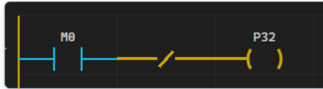
< 그림 5-12 신호 반전 기본 예제 — M0 OFF, 반전을 거쳐 P32 ON >
